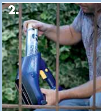
2. ... den Farbkänter in die batteriebetriebene Farbpistole einsetzen,
